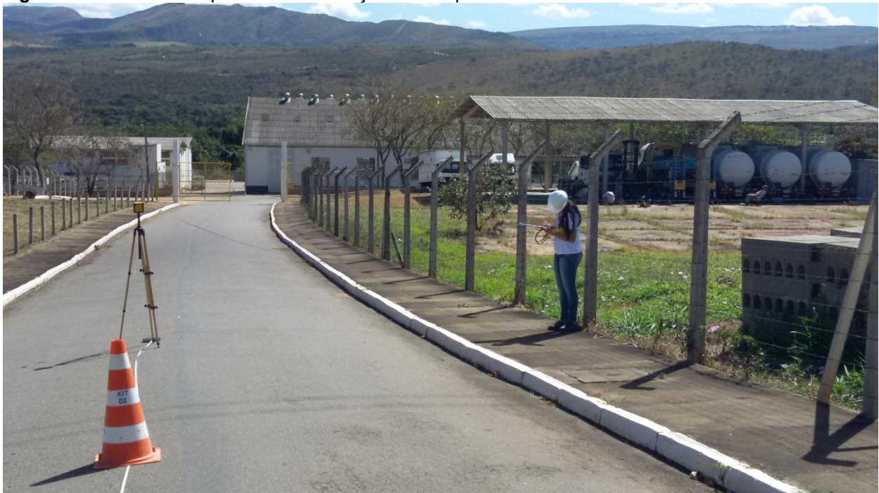
Figura 29: Realizando o processo de medição do campo elétrico.
