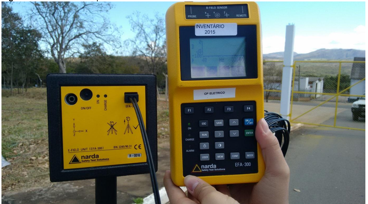
Figura 10: Medidor de campo elétrico - EFA 300. Fab. Narda.
