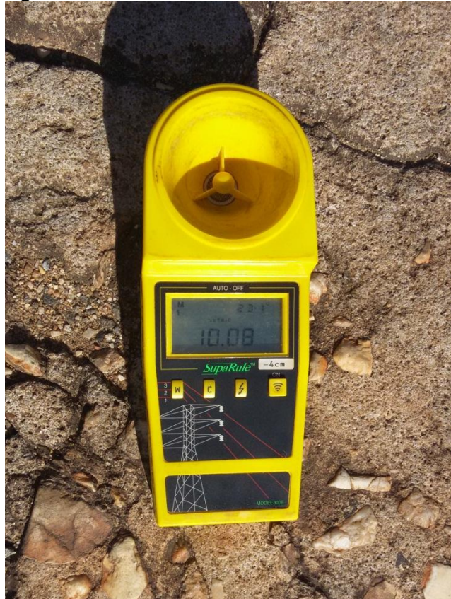
Figura 9: Medidor de altura dos cabos condutores - Saparulle.
