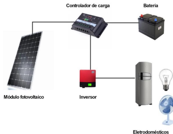
Figura 9: Componentes de um sistema fotovoltaico off-grid típico.
