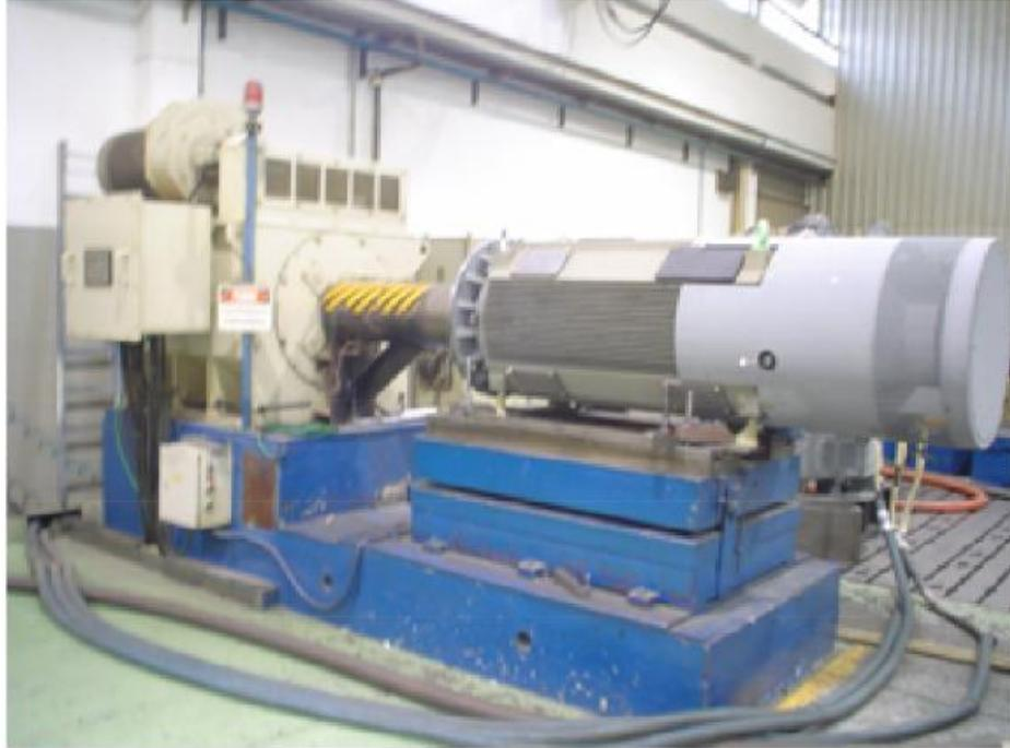
**Figura 7- Motor de 600KW acoplado a um dinamômetro (BAUER, 2008).**
