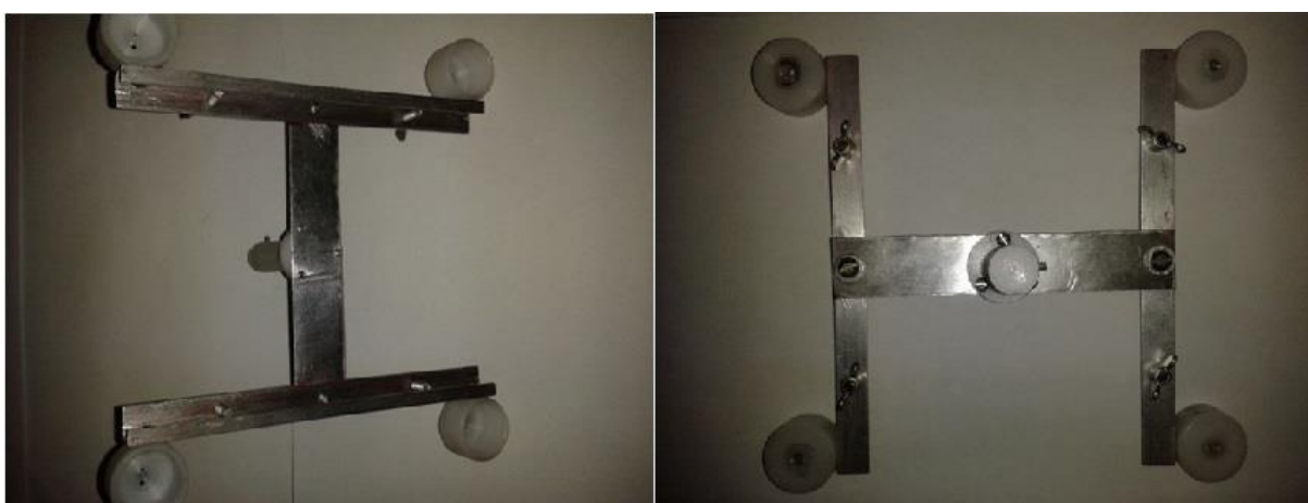
Figura 26 - Peça de acoplamento do painel e sensores ao motor vertical.
