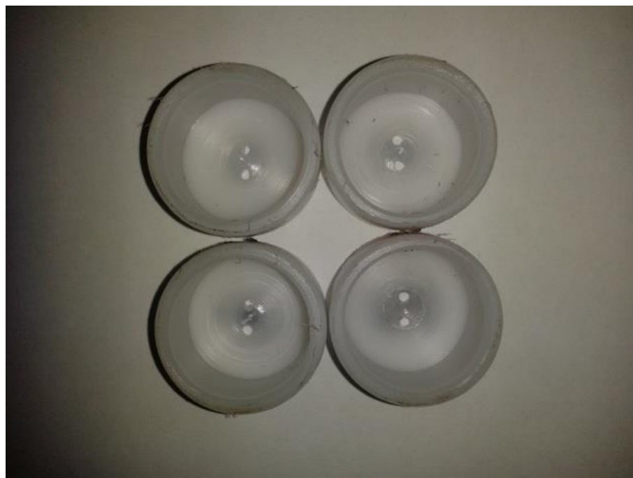
Figura 27 - Suportes para LDR's com os furos de passagem.
