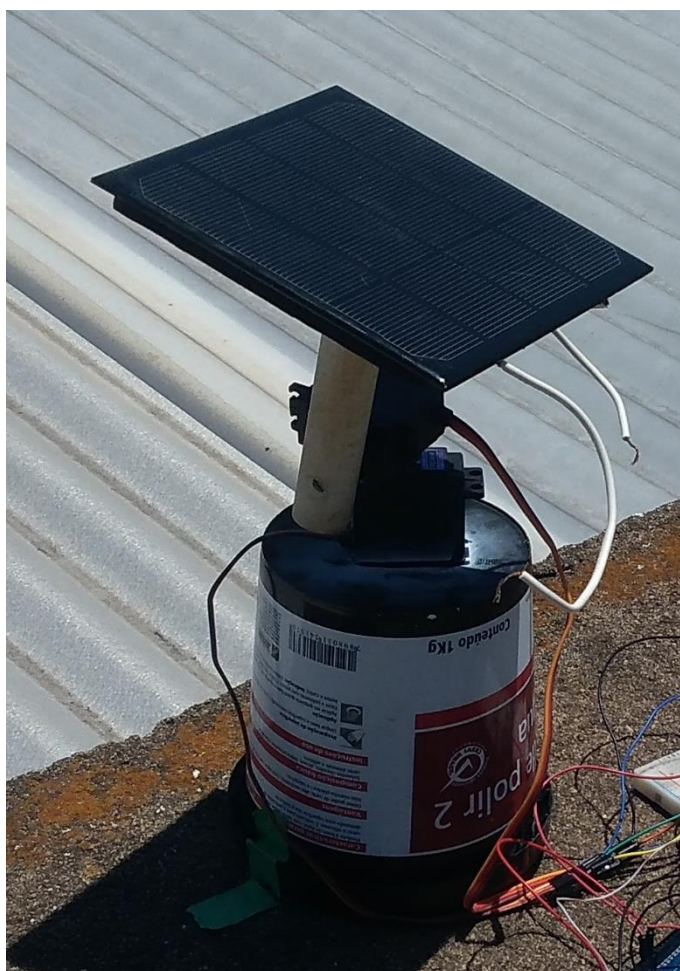
Figura 30 - Estrutura final do protótipo de seguidor solar por algoritmo fixo de controle.
