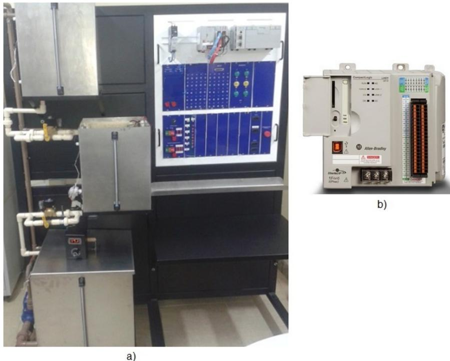
Figura 4.25: Planta didática de Controle de Temperatura e Nível de Tanques.
