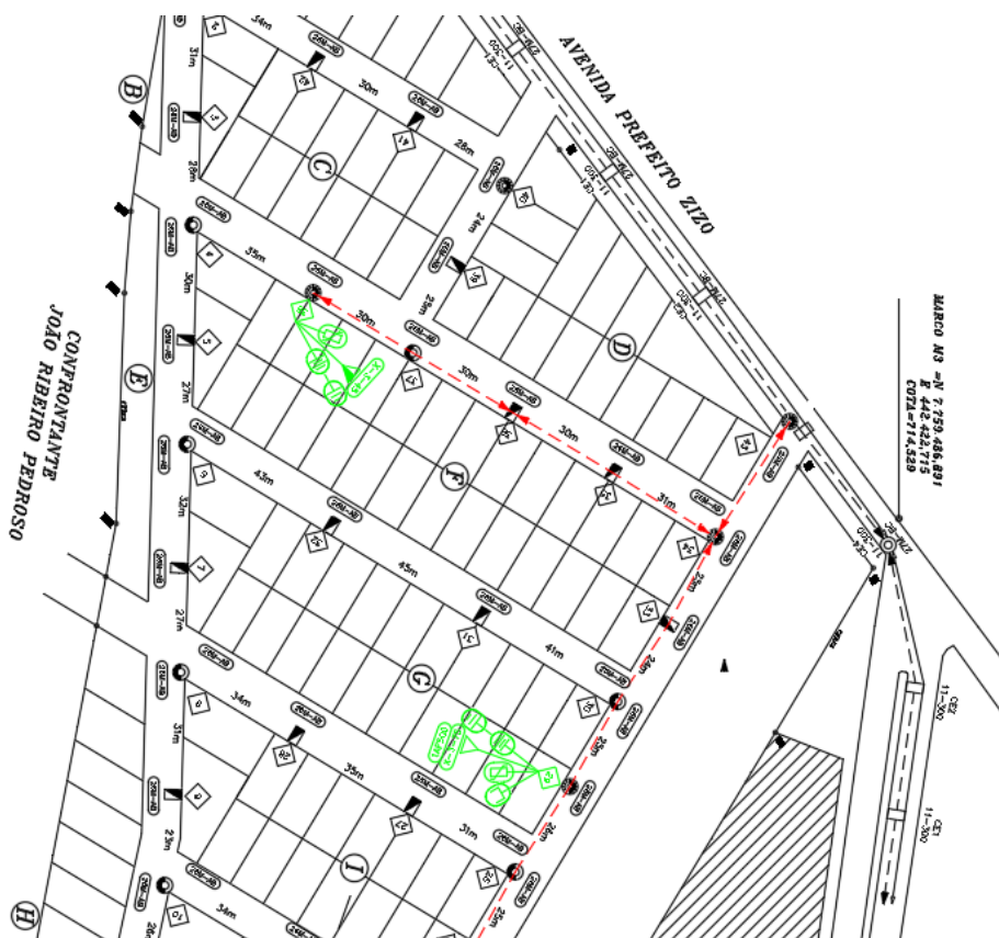
Figura 30 - Circuito de média tensão - Transformadores B e C.
