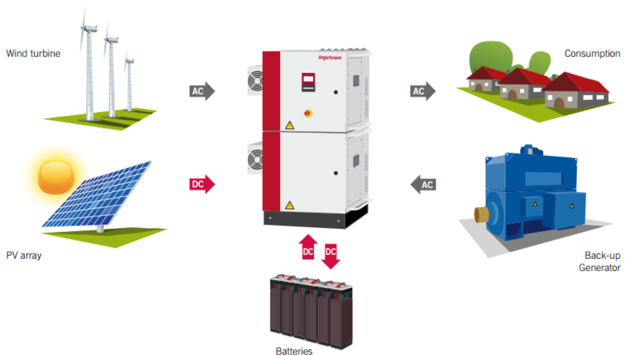
Figura 25 - O sistema Ingecon Hybrid MS indicando suas entradas e saídas. Figura extraída de (INGETEA, 2016).
