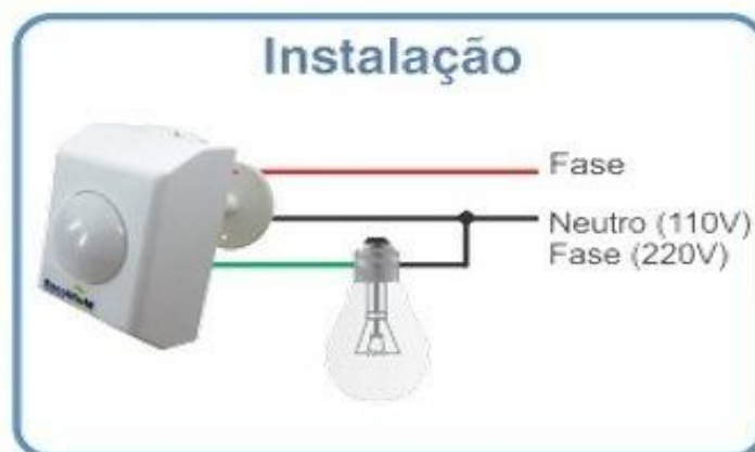
Figura 39 - Instalação Sensor de presença.
