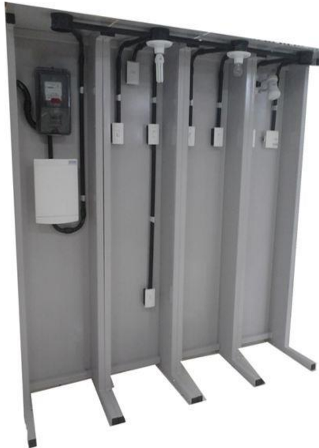
Figura 9 - Kit modular de Instalação Elétrica Residencial (KMIER-01)
