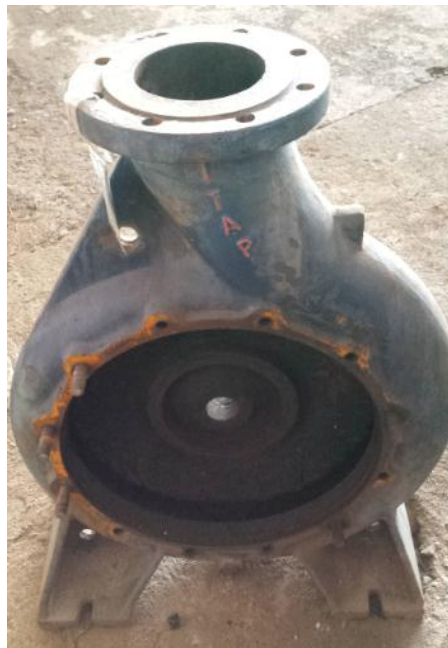
Figura 38 - Bomba centrífuga tipo voluta ou caracol. Fonte: Da própria autora.
