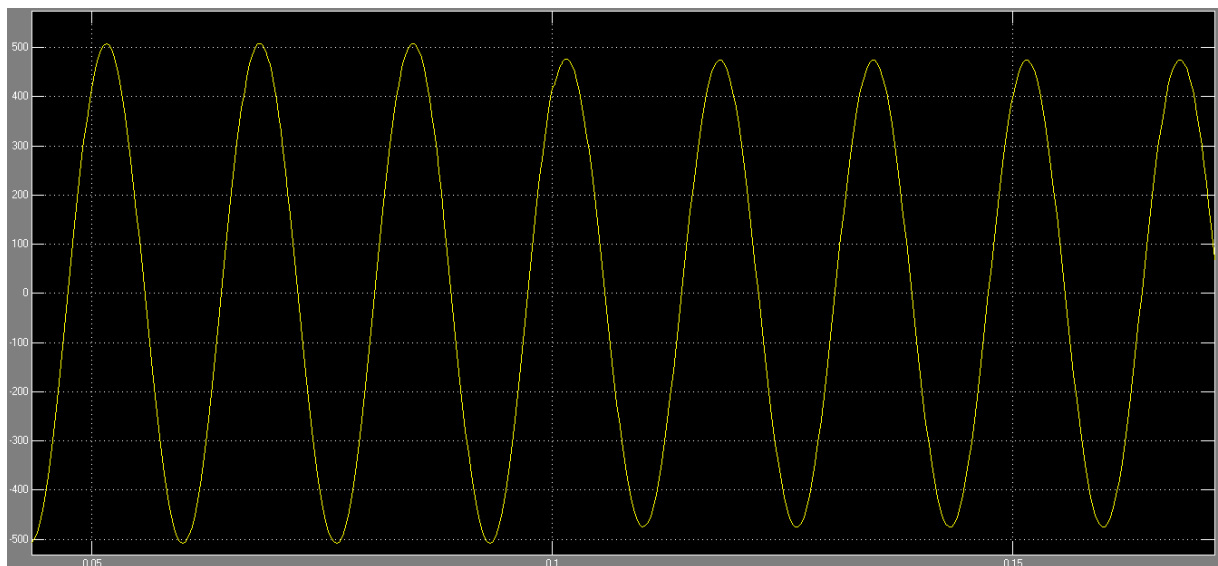
Figura 64 - Afundamento de tensão na partida direta com transformador de 150 kVA.
