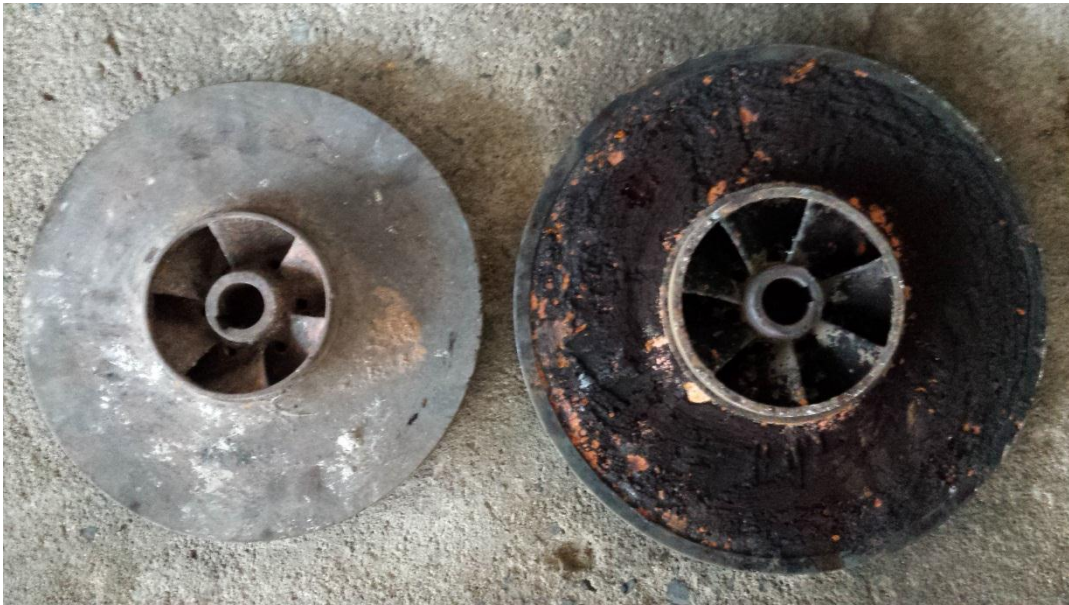
Figura 39 - Rotor utilizado em bomba acoplada ao motor de 100 cv (à esquerda) e ao motor de 150 cv (à direita).
