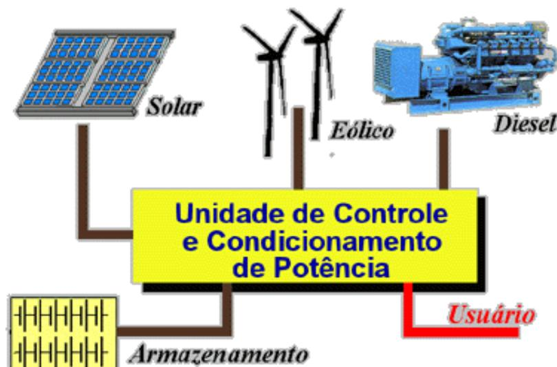
Figura 7: Sistema fotovoltaico híbrido.
