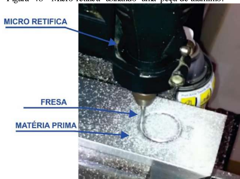
Figura 48 - Micro retifica usinando uma peça de alumínio.
