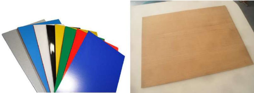
Figura 26 - Placas de ACM e compensado de madeira.
