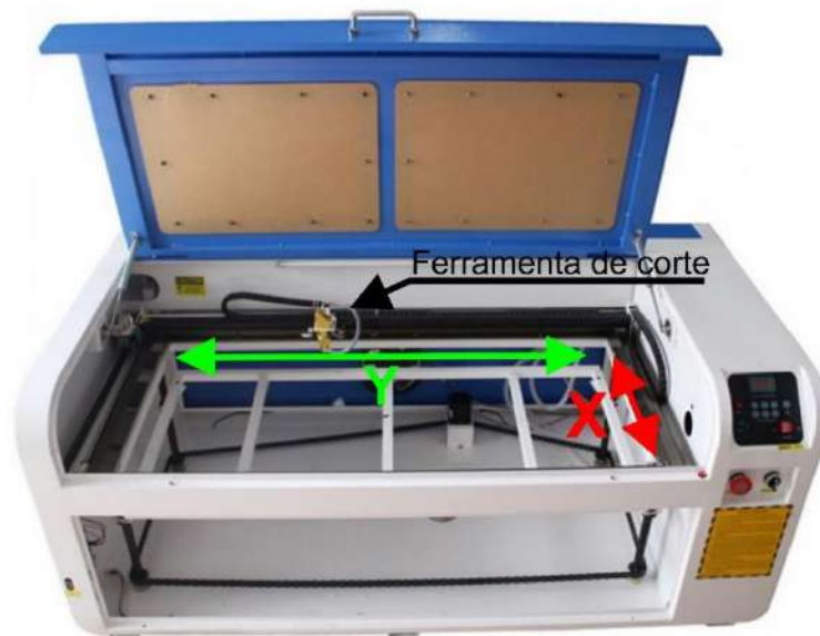
Figura 12 - Esquema de deslocamento de uma laser CNC de 2 eixos.
