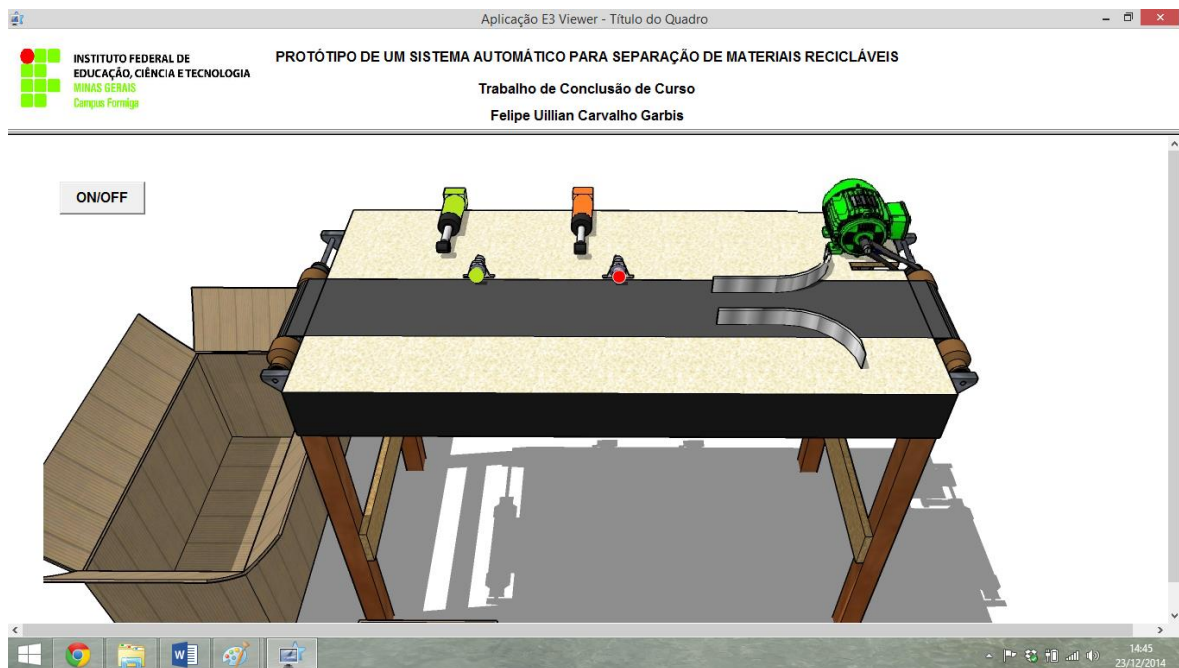
Figura 33 - Sistema Supervisório Atuando.
