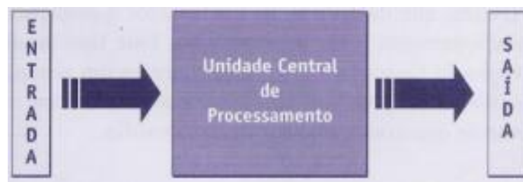
Figura 9 - Estrutura Básica de um CLP.
