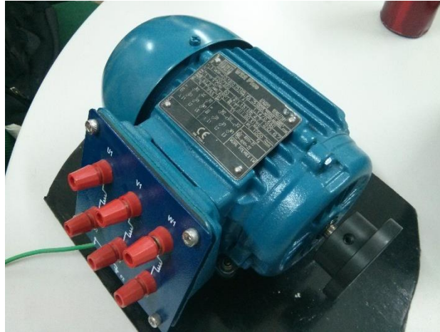
Figura 19 - Motor de Indução Trifásico.
