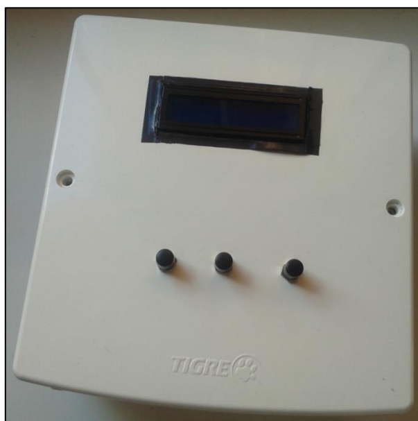
Figura 38: Layout do dispositivo de controle de temperatura.
