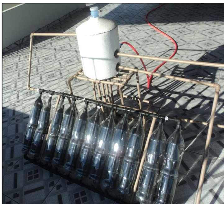
Figura 25: Protótipo do aquecedor solar de garrafa PET.
