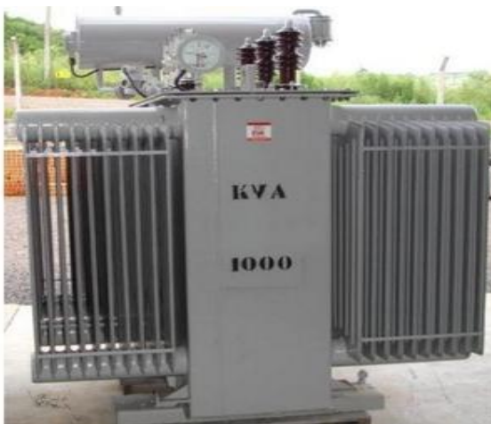
Figura 21 - Transformador de potencial com isolação a óleo
