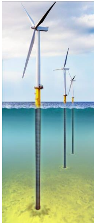
Figura 28 - Estrutura monopilar offshore .
