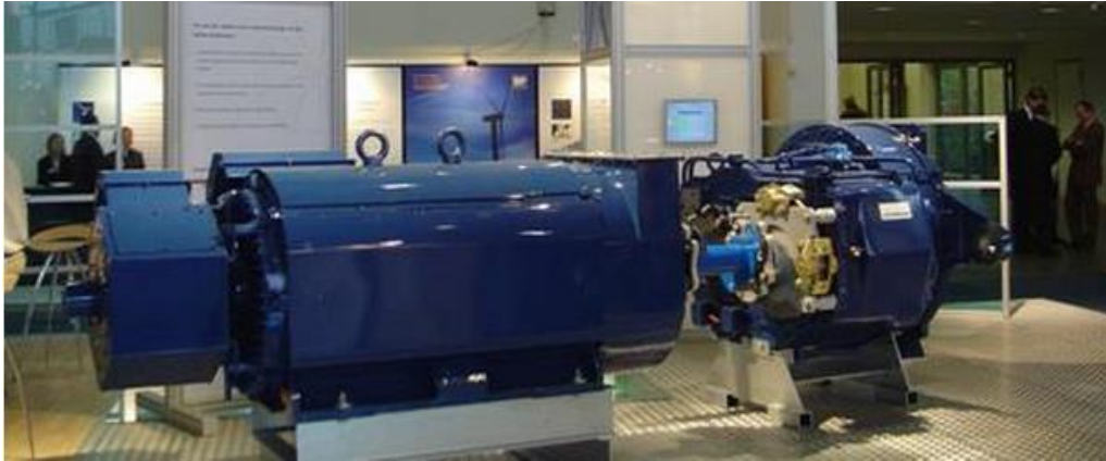
Figura 33 - Gerador conectado à caixa de engrenagens (à direita).
