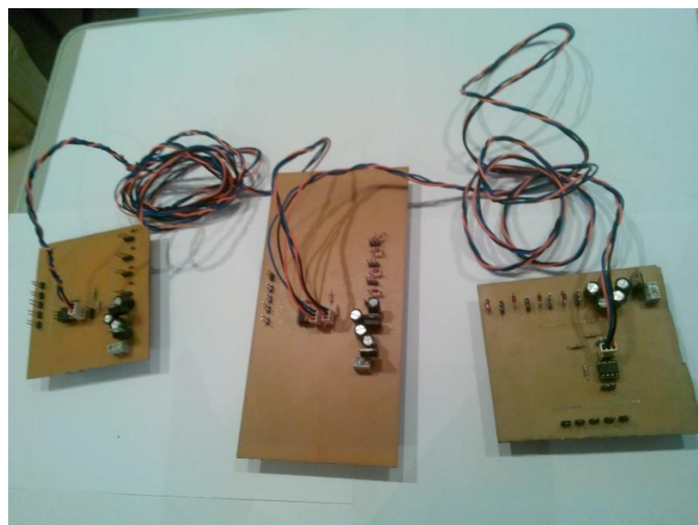
Figura 29 Controlador Mestre (centro) e Escravos conectados.
