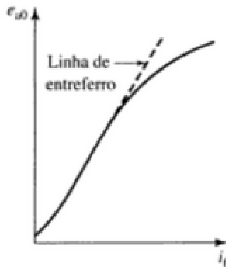
Figura 10 - Forma típica de uma curva de magnetização de uma máquina CC.
