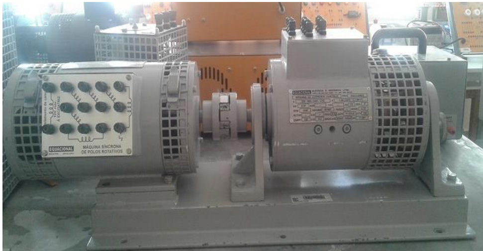
Figura 21 - Conjunto didático: máquina síncrona acoplada à máquina CC.
