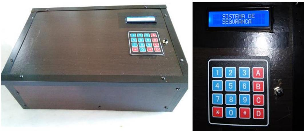
Figura 34 – Módulo de controle com detalhe para o teclado, o display LCD e botão de controle utilizados.
