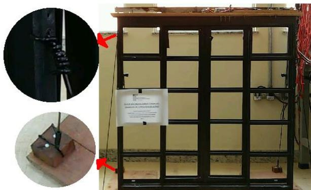
Figura 11 – Detalhes das amarrações dos esteios nas extremidades inferior e superior.
