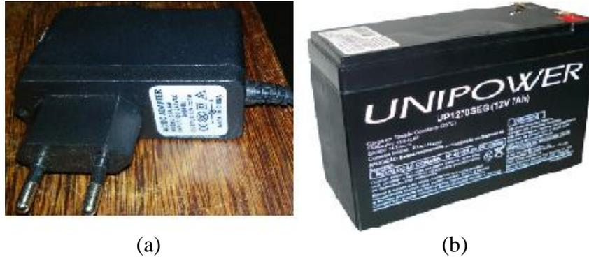
Figura 29 – Detalhes das fontes alimentadoras do sistema utilizadas: (a) chaveada e (b) bateria.
