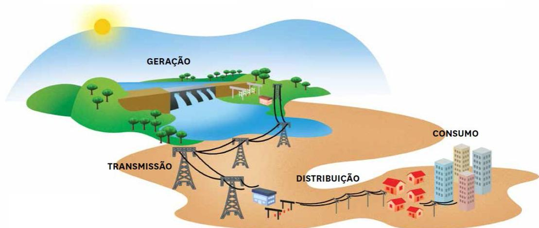
Figura 2 - Segmentos do Setor Elétrico
