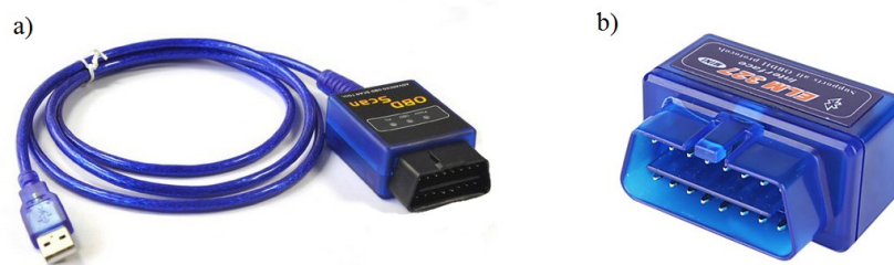
Figura 3 – Adaptadores OBD a) Transmissão via USB b) Transmissão Via Bluetooth
