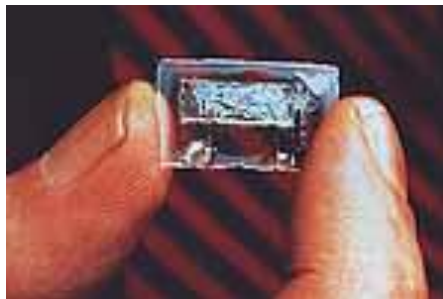
Figura 2 – Fotografia do primeiro circuito integrado. Figura extraída de: (TEXAS INSTRUMENTS).
