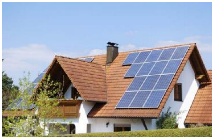
Figura 2.4 – Sistema fotovoltaico distribuído conectado à rede elétrica. Fonte: Casa da Sustentabilidade, 2015.
