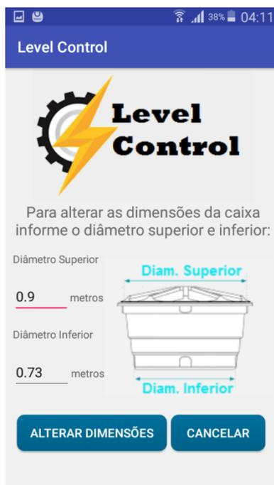
**Figura 31: Tela para alteração das dimensões do reservatório.**
