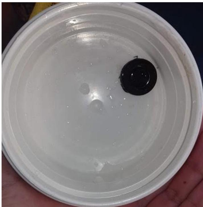
**Figura 17: Situação do sensor após a condensação do vapor de água.**
