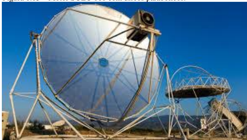
Figura 1.13 – Motor SOLO 161 com discos parabólicos.
