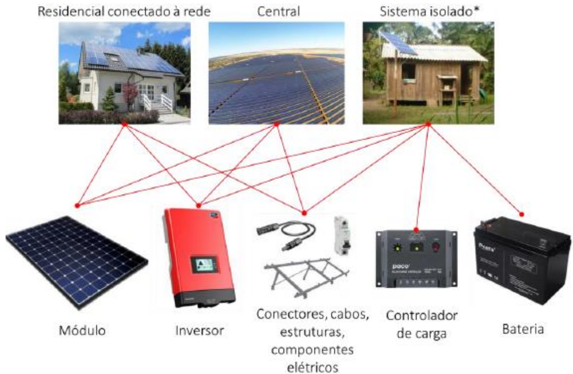
Figura 1.3 – Principais componentes de sistemas fotovoltaicos.
