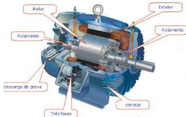
Figura 3.1 – Motor de indução trifásico.
