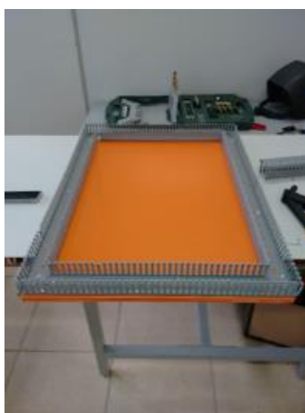
Figura 12: Fixação das Canaletas.
