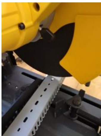
Figura 11: Corte da Canaleta.
